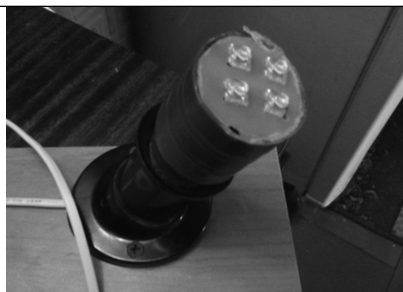
Светодиодная лампа собственной сборки
