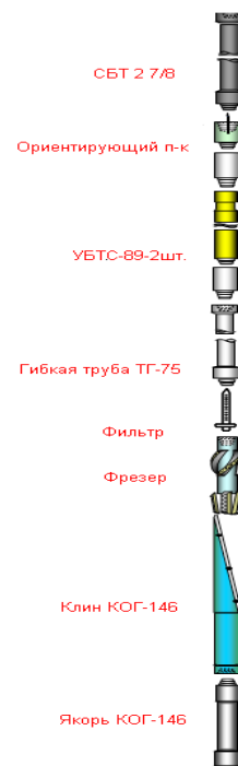
рис.1. Компоновка низа бурильной колонны-вырезание окна в колонне.
